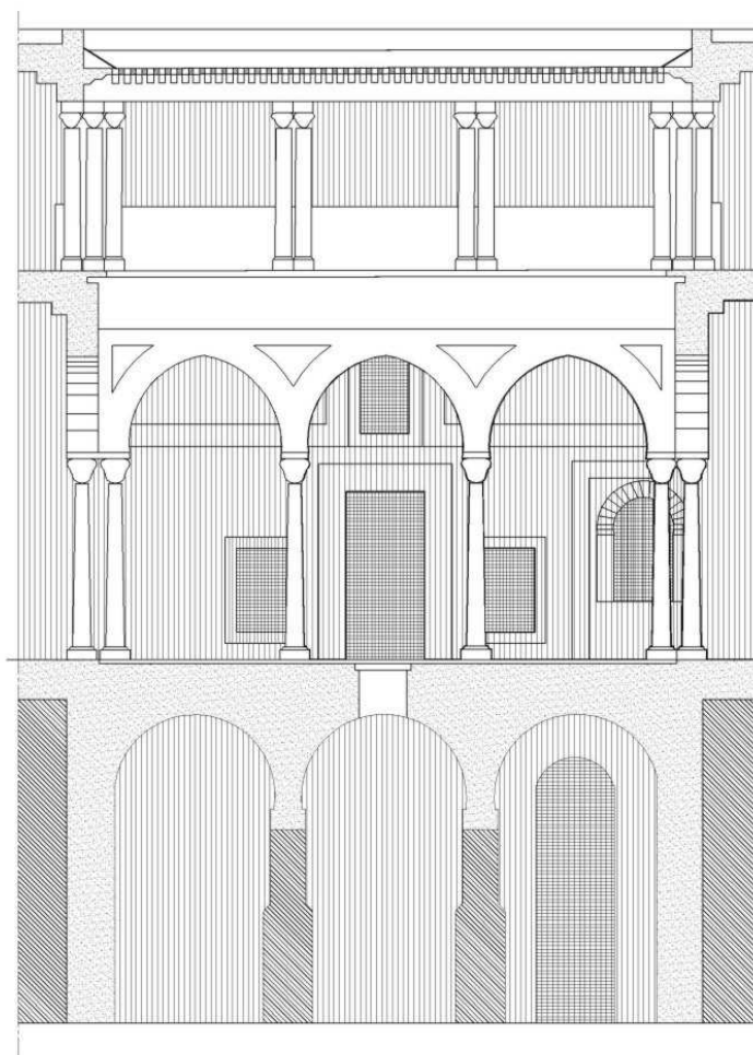
مقطع مع واجهة داخلية : تراكب الماغل ووسط الدار المخاط بالبراطل
