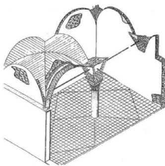
مختلف أنواع الأقبية (أدماس نصف دائرية وغيرها ، تريعات) تصاغ الطبقة الأولى من الآجر بو3 أو بو6 ويقع وضعها بملاط جبسي
