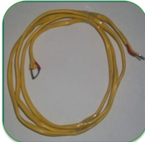
Thermocouple de type K
