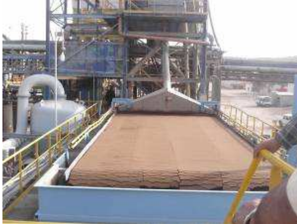
Photo 1 : Enrichissement du phosphate par lavage et séchage à M'dhila
