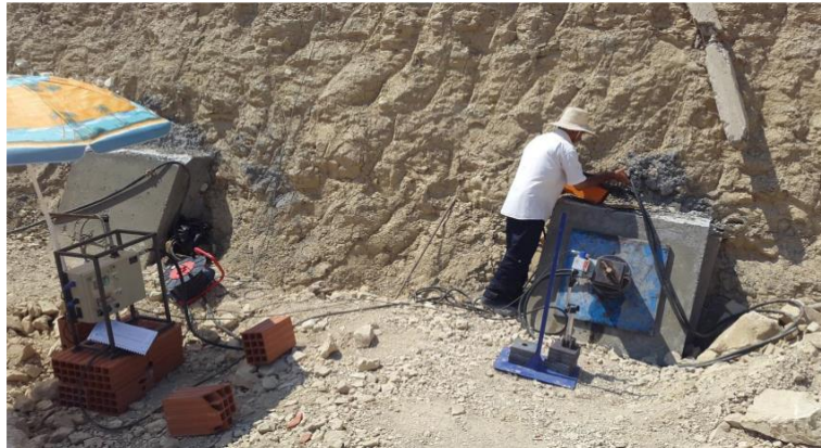
Figure 5. Equipement utilisé lors du suivi de l'essai d'arrachement sur un clou HA32
